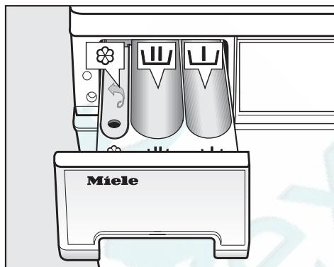
■ Выдвиньте отсек для моющих средств и заполните ячейки моющим средством.
